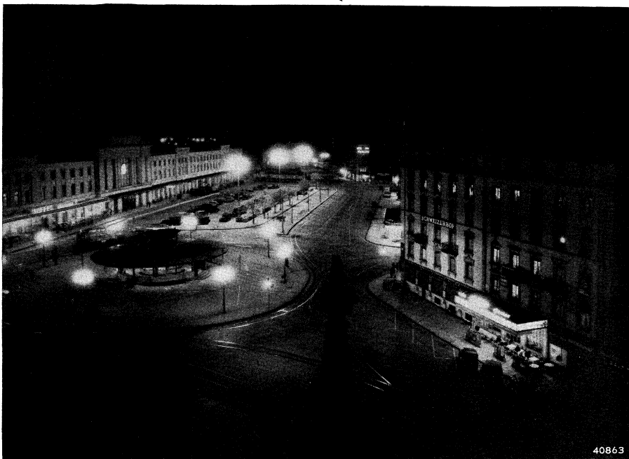
„Place Cornavin“ te Genève. De verlichting bestaat uit 3 kroonluchters van 10 M hoogte. Elke kroonluchter heeft 2 armaturen met gloeilampen van 1500 Watt en 2 armaturen met 2 Philora kwiklampen HO 2000.
